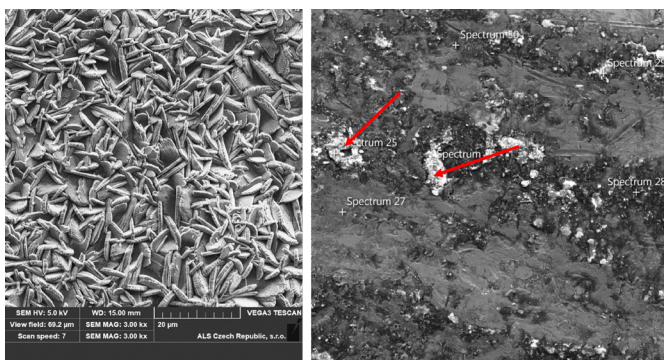
Slika 2.: (A) antikorozivni sloj; (B) tragovi korozije
